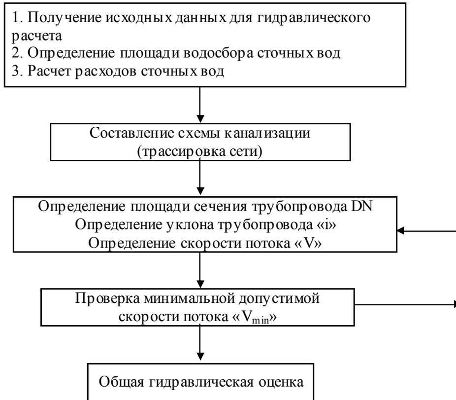
Рис. 3 Алгоритм гидравлического расчета.
