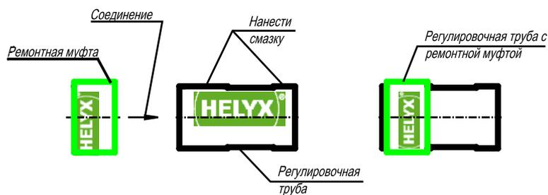
На поверхности земли производят соединение ремонтной муфты с регулировочной трубой путем надвигание ремонтной муфты полностью на длинную отшлифованную часть регулировочной трубы и производят монтаж к месту производства ремонтных работ.
