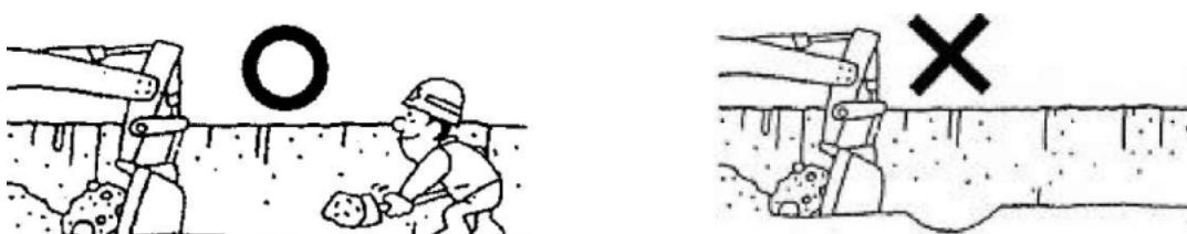
Рис.44. Разработка грунта в траншее
