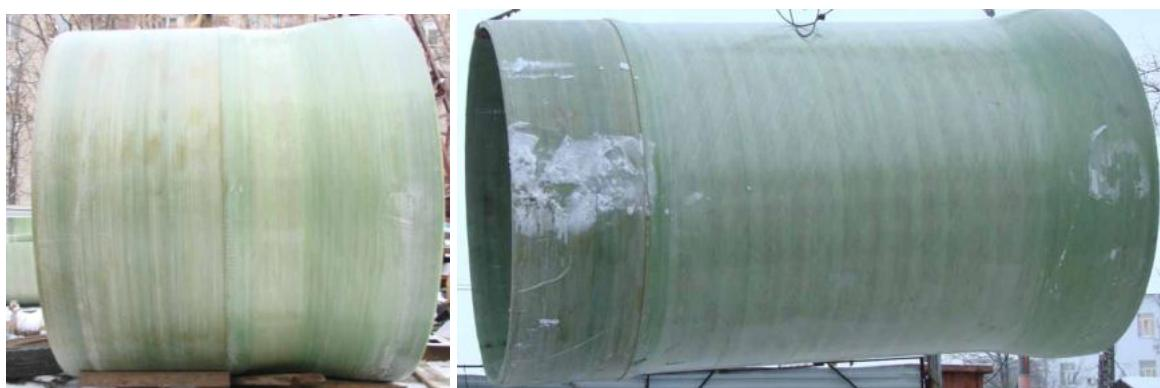
Рис.54. Регулировочная труба
