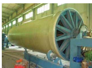
Изготовление внутреннего слоя
