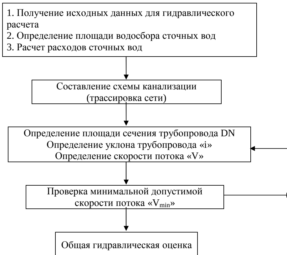
Рис. 17 Алгоритм гидравлического расчета.
