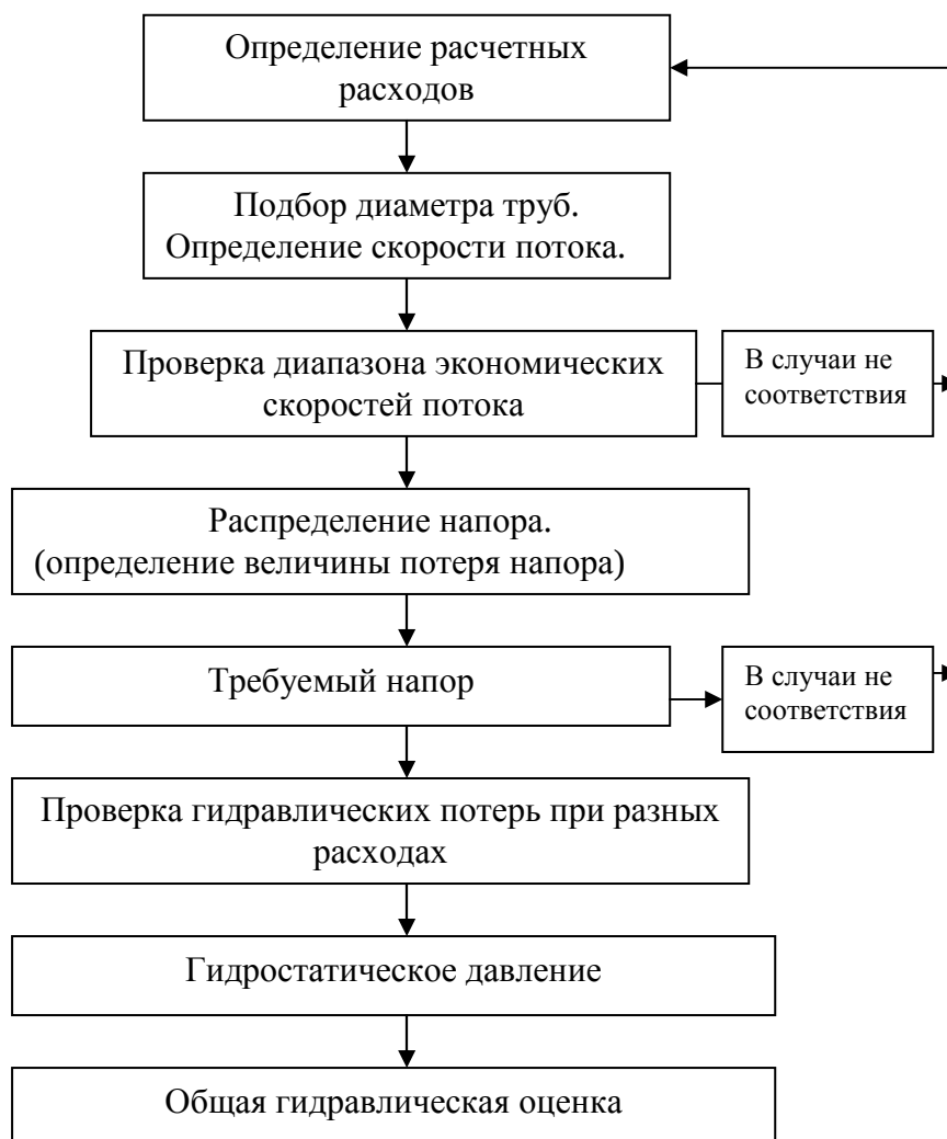
Рис. 19 Алгоритм гидравлического расчета.
